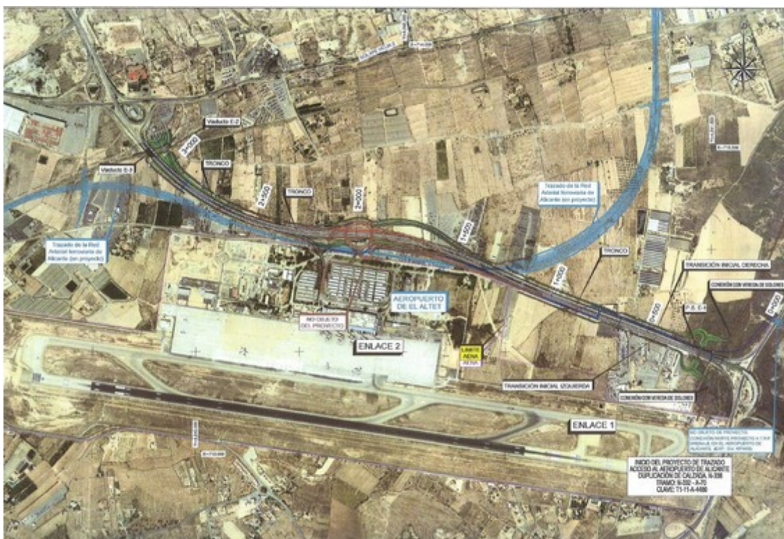
Figura 36: Proyecto de trazado acceso al aeropuerto de Alicante. Fuente: Demarcación de Carreteras del Estado en la Comunidad Valenciana. Ministerio de Fomento.
